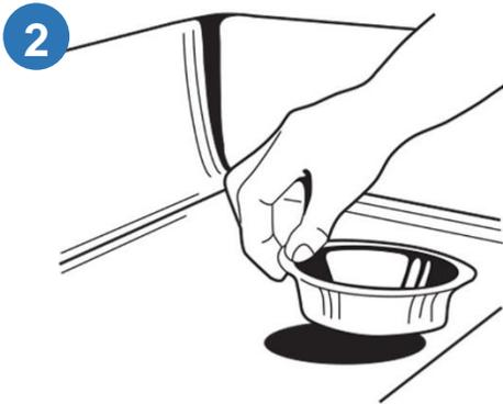
Empuje hacia arriba la brida del fregadero a través del orificio y retírela.
