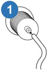
1 Inserte el tubo de PVC en el canal del fuelle del botón.
