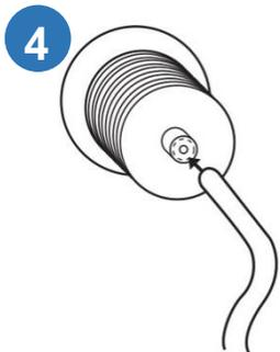
Introduzca un extremo del tubo de PVC en el canal del fuelle del botón y pase el otro extremo a través del orificio de la mesa, y luego a través de la tuerca por debajo de la mesa.
